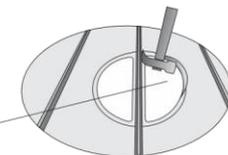
**Atenção:** Proceder com cuidado a dobra junto a viga de sustentação, por tratar-se de local crítico de vazamento d'água (chuva).
