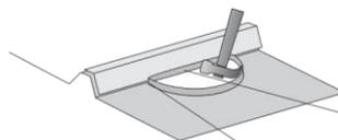
Dobrar parcialmente com a alicate esses 2 cm, em seguida rebater para cima a chapa com o martelo para formar o encaixe macho do anel adaptador de inclinação (fêmea).
