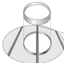
Proceder o recorte com tesoura no anel adaptador conforme o formato da viga de sustentação do silo
