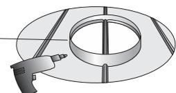
Proceder a furacção e a fixação com parafusos do adaptador na cobertura do silo.
